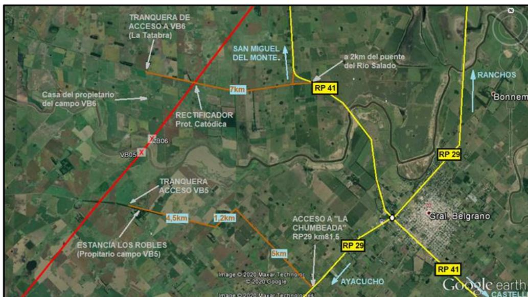
Figura 12 - Vías de comunicación. Cambio de traza – Cruce dirigido río Salado.
